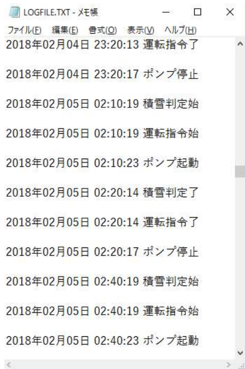
画像-3 ロギングデータの実例（SDカード保存）
