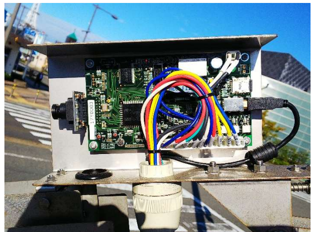
写真-1 マイコン画像処理型積雪センサの基板
