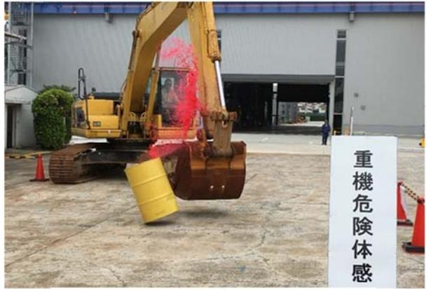
バックホウ旋回による激突体感
