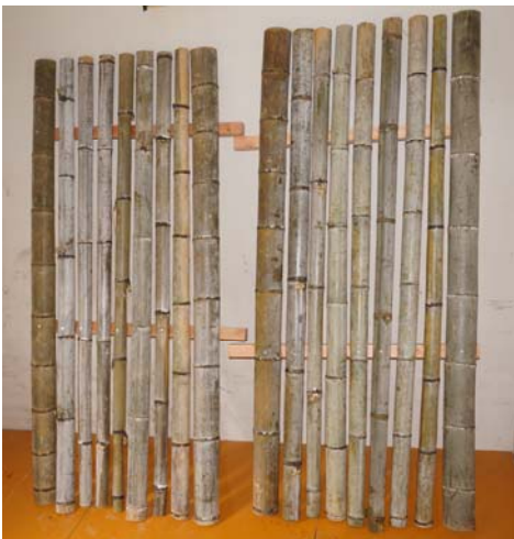
図-10 竹の被覆工(設置前)
