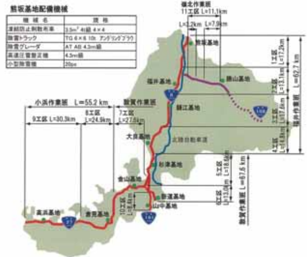
図 - 6 福井管内の除雪工区
