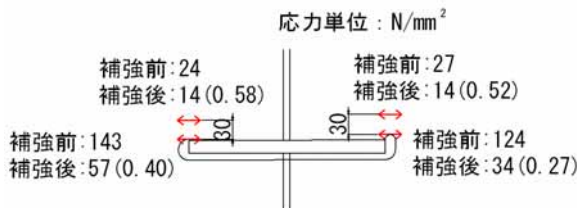
図-8 補強前後の横桁貫通部の発生応力 (G3, C6横桁貫通部 (G2側))
