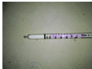
写真-7 濃度測定状況 (検知管)
