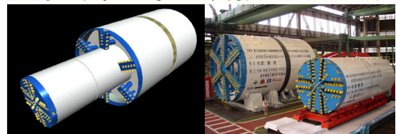
図-1 ハイブリッド式親子シールド工法
