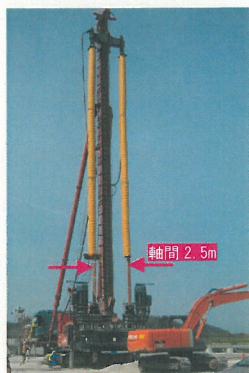
写真-1 HL-DJM施工機械の概要
