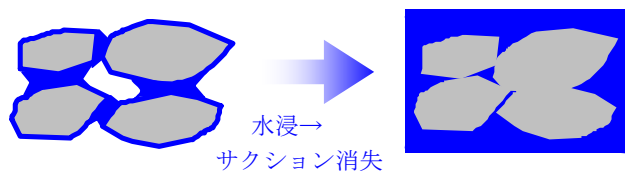
図-4.1 水浸によるサクシオン消失のイメージ
