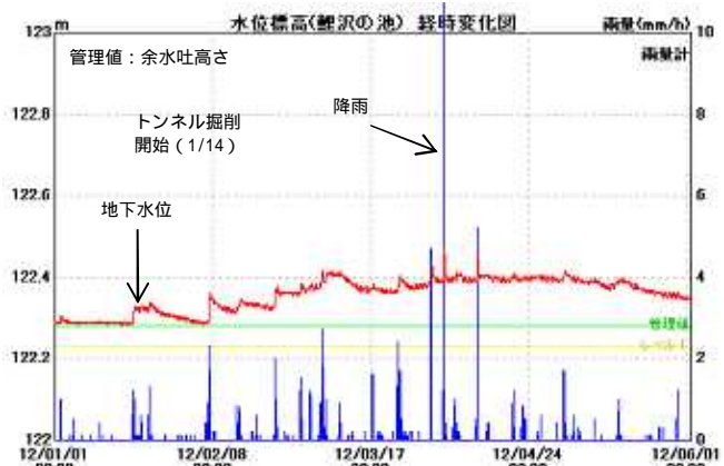
図-10 鯉沢の池の地下水位状況
