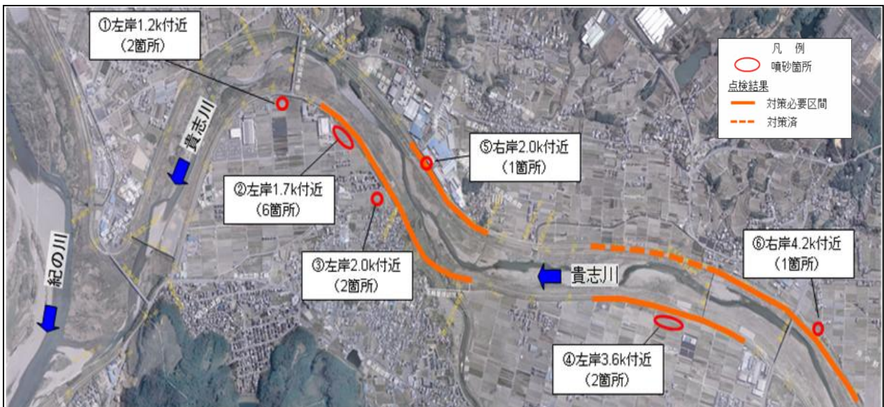
図-2 噴砂箇所と堤防点検結果
