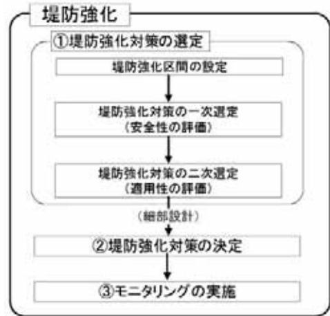
図-6 堤防強化の手順 「手引き」p.53より
