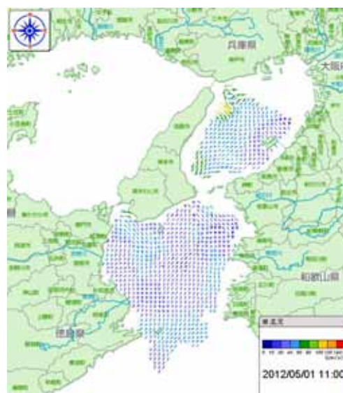
図-9 大阪湾・紀伊水道海洋レーダ表層流況配信システム表示例
