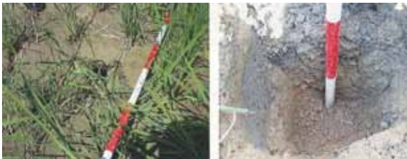
1) 写真-3.4 憤砂孔(左)と憤砂孔の横の土層構成(右)
