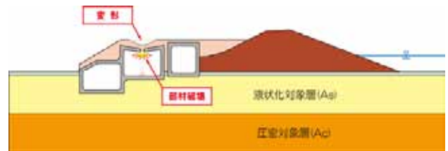
図-8 経年変化に伴う被害想定イメージ図 (完成時)
