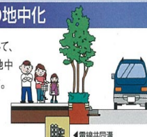
電線類の地中化 電力線、通信線などのケーブル収納
