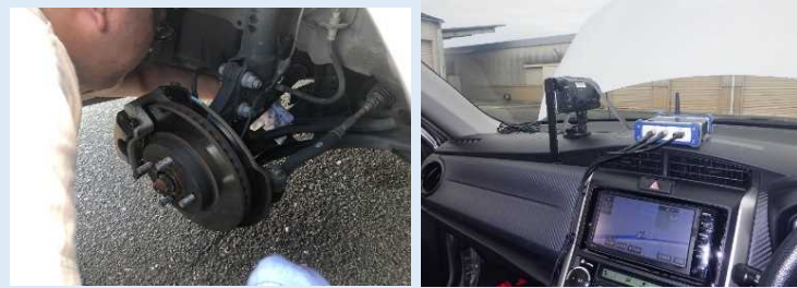
加速度センサー、ACTUS本体設置状況
