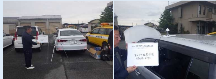
高精度GNSS親局、子局設置状況
