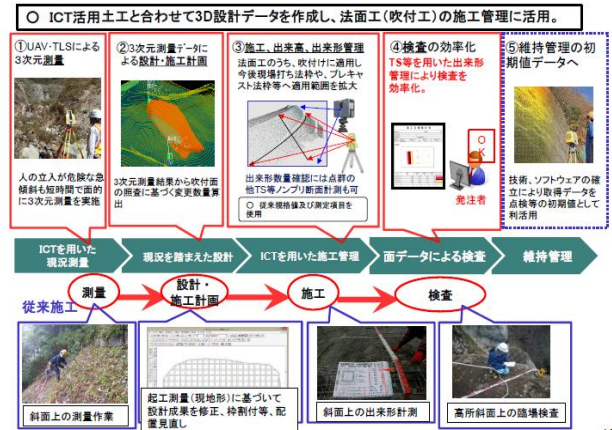
図-18 ICT 法面工(吹付工)
