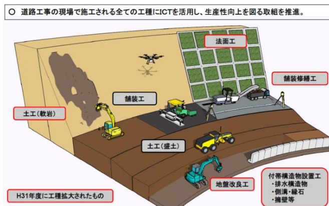
図-17 ICTを活用した道路工事
