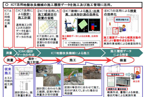
図-19 ICT 地盤改良工(浅層・中層混合処理)
