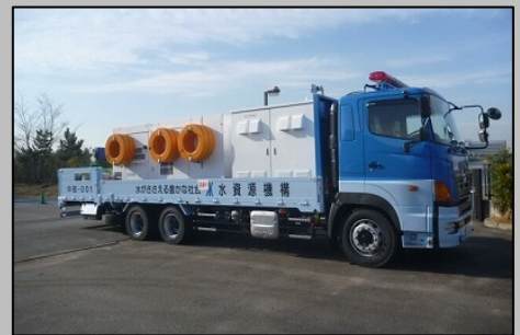
排水ポンプ車
