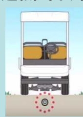
○電磁誘導線を敷設、実験車両を誘導
