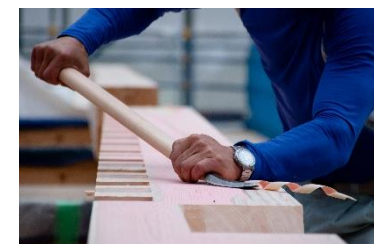
▲実際に使用している道具 ◀ 槍鉋を用いて部材を仕上げる様子 ▼ 麻の布目を再現した平瓦
