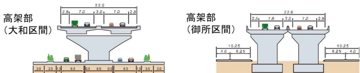
図 大和御所道路の標準断面図
