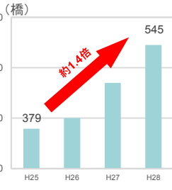
通行止め橋梁の推移 (地方公共団体管理)
