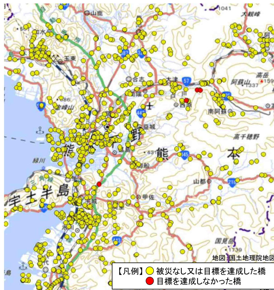
図-2 兵庫県南部地震以降の基準を適用したと考えられる橋の目標達成状況（熊本県内で震度6弱以上を観測した主要地域）
