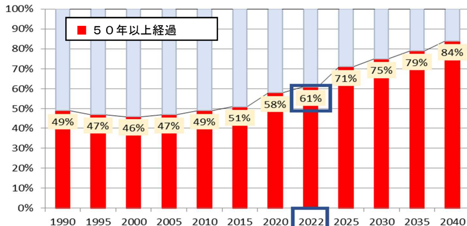
建設後50年が経過する鉄道橋（径間1m以上）の割合
