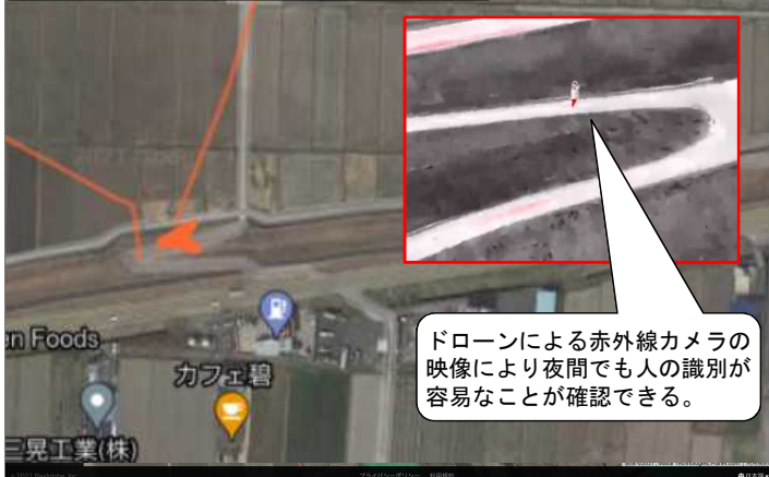
赤外線カメラ搭載ドローンからの映像配信状況。人の確認と位置が同時に確認可能。
