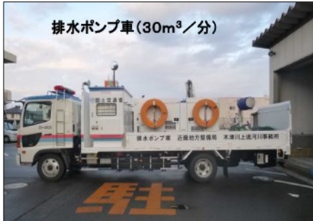
排水ポンプ車
