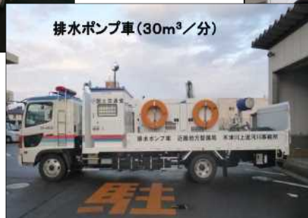
排水ポンプ車
