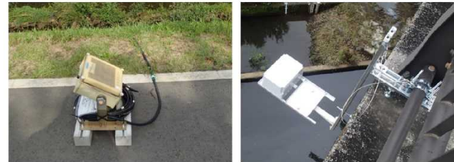
堤防に設置するタイプ （ケーブル（計測器）を河川に入れて計測）
