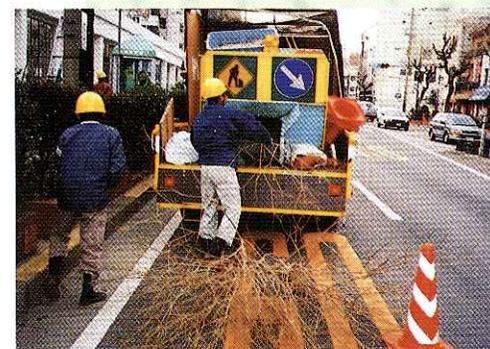
写真-4 A社の移動式破碎機
