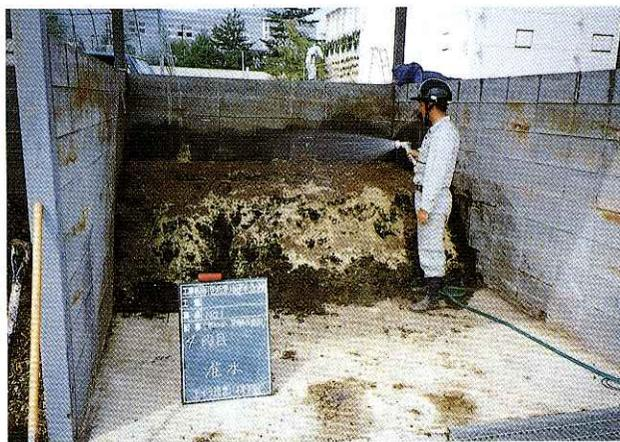
写真-12 培養施設内での水分調整
