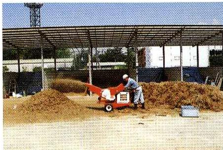
写真-1 小型破碎機械 (例)
