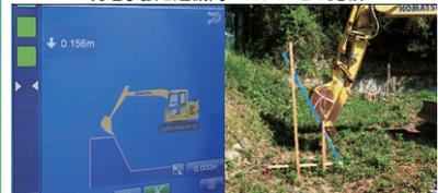
ICT建機(マシンコントロール型バックホウ)のキャリブレーション実施後に、建機内のモニターを見ながら操作したバケットの位置・角度と現地に設置した丁張りが整合していることでICT建機の精度を確認した。
