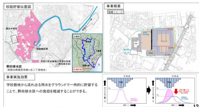
図-11 校庭貯留の実施事例 (緑丘中学校：R3年)
