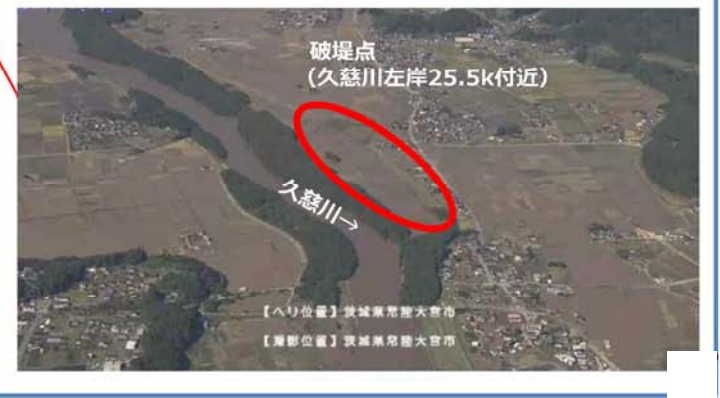
久慈川水系久慈川、里川(茨城県常陸大宮市ほか) 堤防の決壊等により、約1,650haが浸水。市全体で床上浸水475戸、床下浸水87戸(10/15※)の家屋被害等が発生。 ※常陸大宮市ウェブサイト
