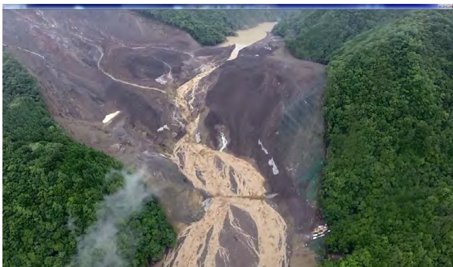
UAVによる出水後の河道閉塞部の撮影（赤谷地区） 平成26年8月 台風11号
