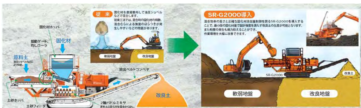
砂防ソイルセメント製造機械（長殿地区）
