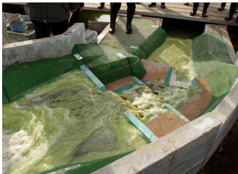
水理模型実験による減勢効果の検証（長殿地区）
