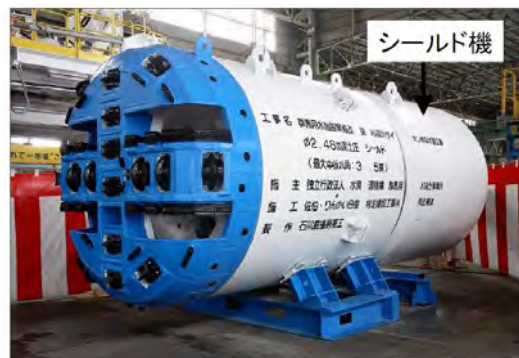
シールド工法（泥土圧式シールド機）
