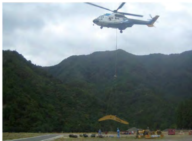
ヘリコプターによる分解型重機の輸送
