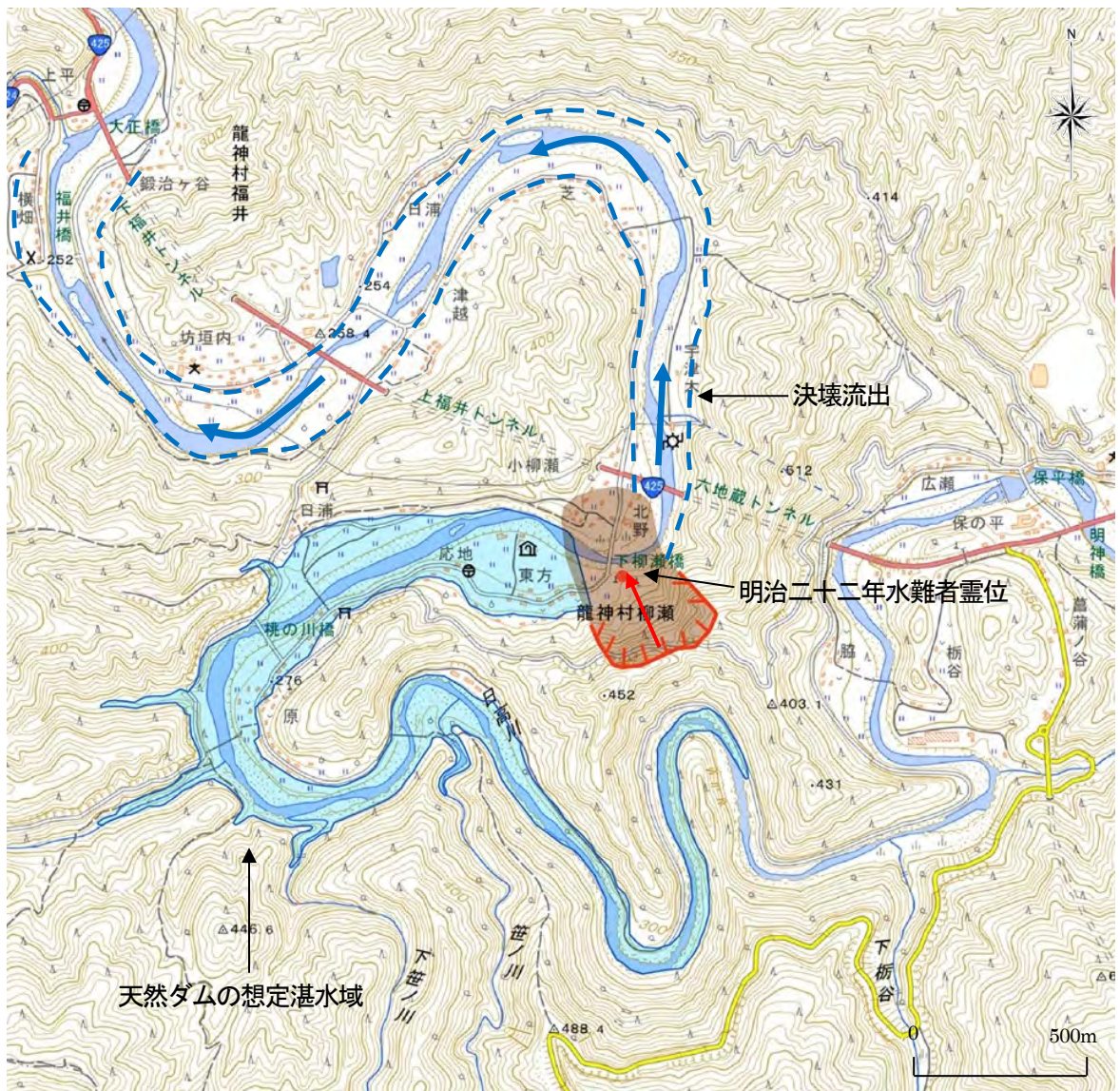
図 12.8 下柳瀬の崩壊と天然ダム形成・決壊の災害状況図 (地国土地理院 1/25000 地形図「西」を使用)
