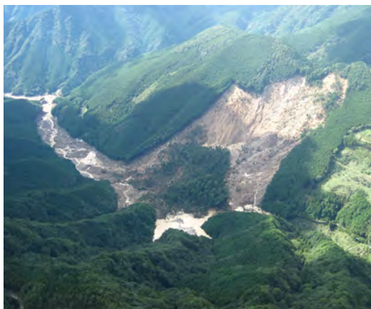
熊野地区における深層崩壊と河道閉塞
