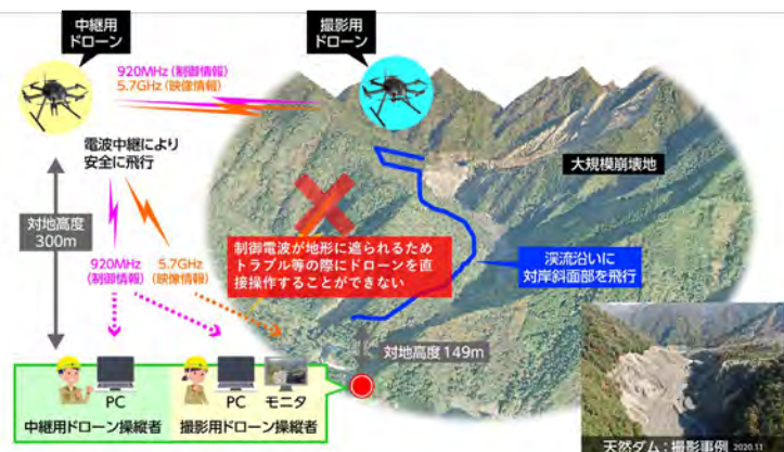
ドローン2機を併用した電波中継技術による崩壊地調査
