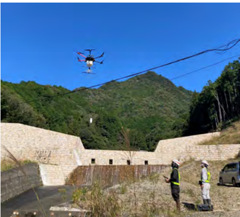
ドローンによる空中電磁探査
