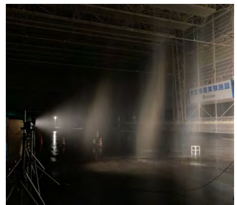
カメラによる降雨強度推定実験
