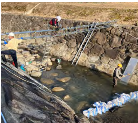
電極板を用いた流砂量観測
