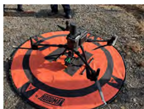
レーザ搭載ドローン
