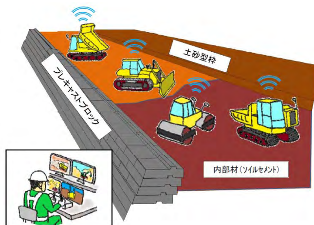
赤谷地区における自動化施工イメージ図
