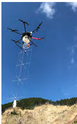
ドローンを活用した空中電磁探査による地下水状況の推定
