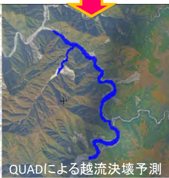
ドローンレーザを用いた天然ダムの計測と越流氾濫予測技術
