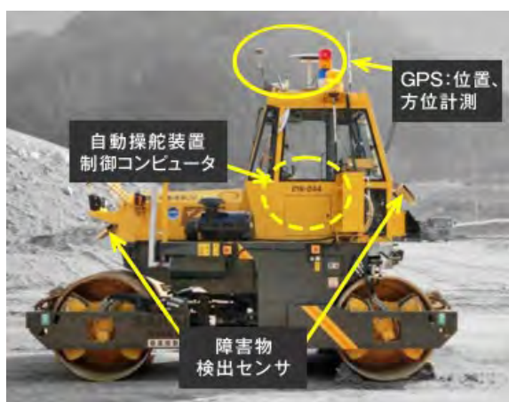
自動化装備を施した重機(振動ローラ)
