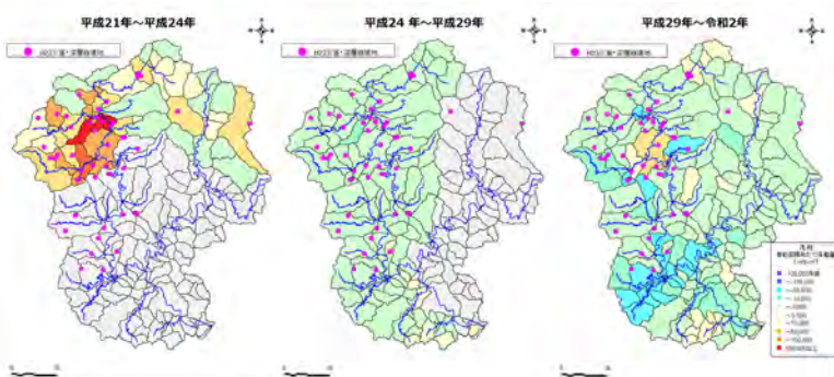
熊野川流域における土砂変動量の分析
