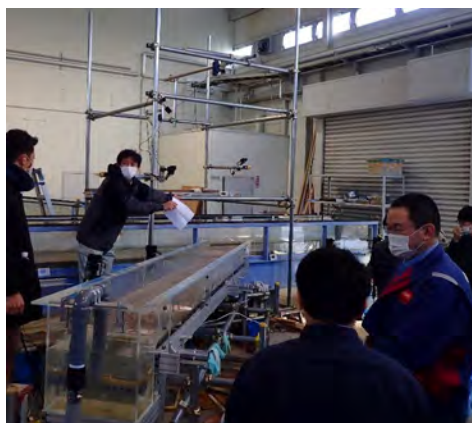
水路実験による土砂堆積実験
