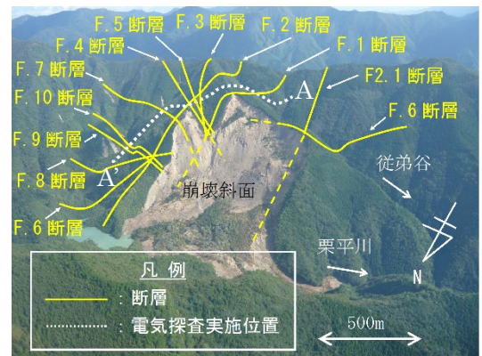
写真-1 崩壊斜面周辺の断層の分布。撮影日は2011年9月10日である。白い点線は図-4での電気探查の測線を表す。矢印は流向を示す。
