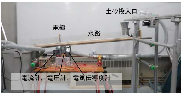
図-5 作製した実験水路
