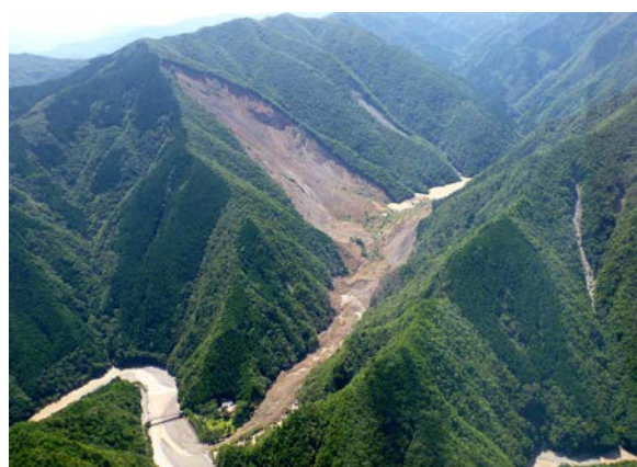
図-2 2011年台風第12号による豪雨で発生した河道閉塞(天然ダム)(熊野川流域五條市 赤谷 2011.9.6 土研土砂管理研究グループ撮影)
