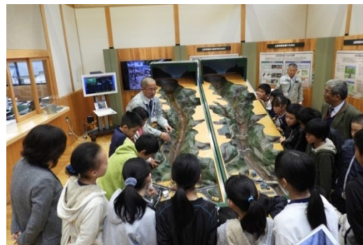
写真-3 土石流発生装置による砂防堰堤の効果に関する実験の様子
