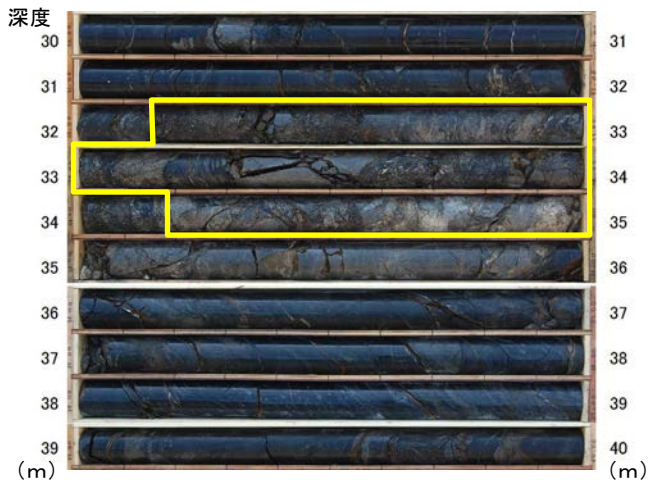
写真-3 ボーリング調査の結果得られた、断層によるとみられる亀裂(ボーリング孔 H24-1)。黄色で囲まれたコアは、F.9断層であり、主に固結砂礫状を呈し、亀裂に富んでいる。
