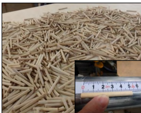
写真-5 供給した流木の模型
