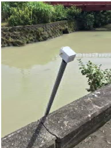
図4 御坊に設置された水位計
