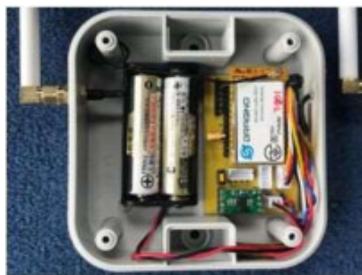
図 4 LoRa 通信機能を搭載した IoT 端末
