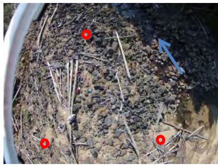
写真-7 河道閉塞箇所の対空標識設置の様子 (○印は対空標識の位置を、矢印は下流方向を示す)
