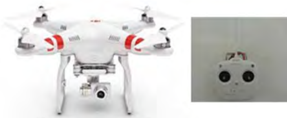
写真-1 UAV本体（Phantom2Vision+）と送信機
