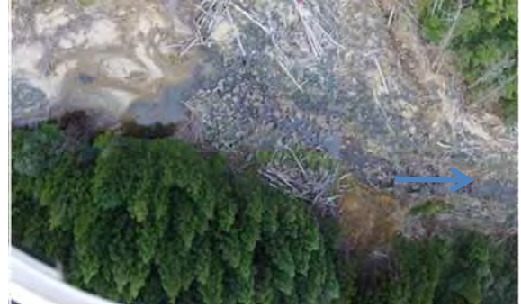
写真-10 UAV で撮影した河道閉塞箇所の様子 (高度 50m, 矢印は下流方向を示す)
