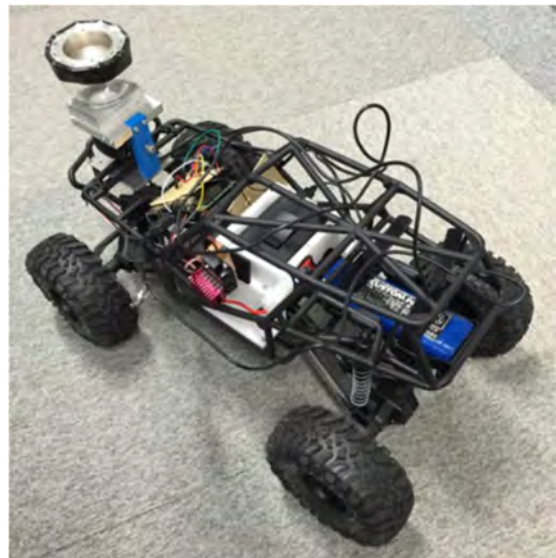
図-2 全方位カメラを搭載した小型UGV
