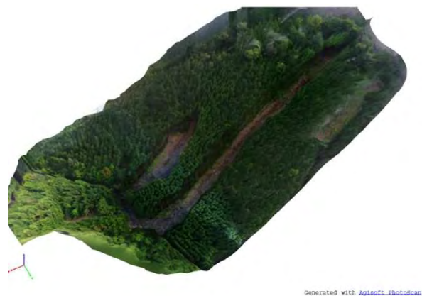
図-8 山腹崩壊箇所の 3D 画像解析モデル
