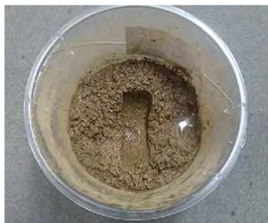
図-7 単輪実験時における轍の形成
