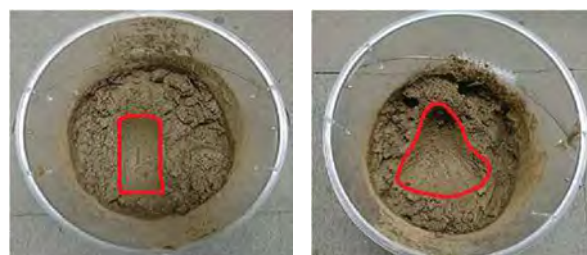
図-8 単輪実験時における操舵角による轍の違い
