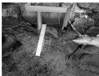
写真-4 下流側の観測箇所の機器設置状況
