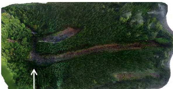
図-5 山腹崩壊箇所のオルソモザイク画像 (矢印は下流方向を示す)
