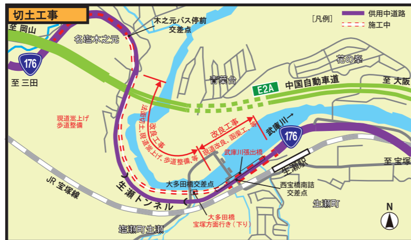
生瀬トンネル周辺の斜面を大きく掘削し、現道を嵩上げ・歩道を整備する幅を確保し、改良工事を推進します。
