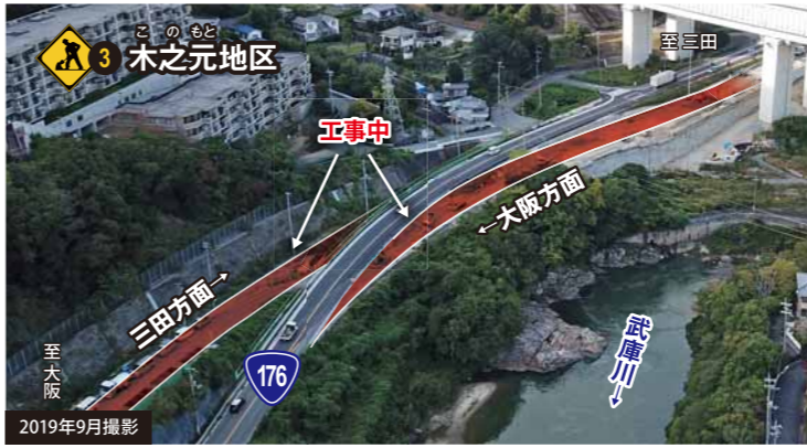
対面通行から、大阪方面行と三田方面行を分離する工事を進めています。
