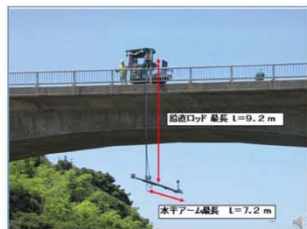
「橋梁点検カメラシステム視る・診る」 による近接目視、打音調査等援助・補完技術 ジビル調査設計
