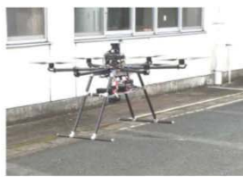
非GPS環境対応型マルチコプターを用いた 近接目視点検支援技術 三信建材工業
