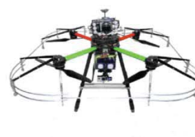
マルチコプターによる 近接撮影と異常箇所への2次元計測 夢想科学
