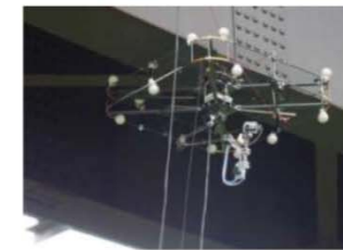
マルチコプターを利用した橋梁点検システム (マルコTM) 川田テクノロジーズ
