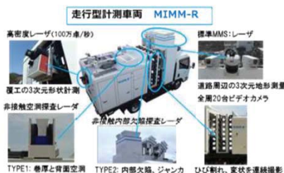
走行型高速3Dトンネル点検システム MIMM-R(ミーム・アール)
