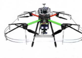
マルチコプターによる 近接撮影と異常箇所 の2次元計測 夢想科学
