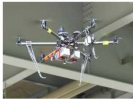
構造物点検ロボットシステム 「SPIDER & Giraffe」 ルーチェサーチ
