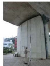
橋梁等構造物の 点検ロボットカメラ 三井俣友建設
