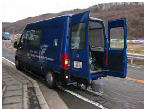
(アスファルト舗装における FWD 調査の実施例)
