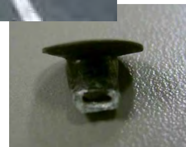
破断したブラインドリベット
