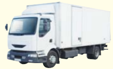
普通貨物車等(ナンバー1,8) 最大積載量5t未満かつ車両総重量8t未満 ※軽および小型規格の特種用途自動車は除く
