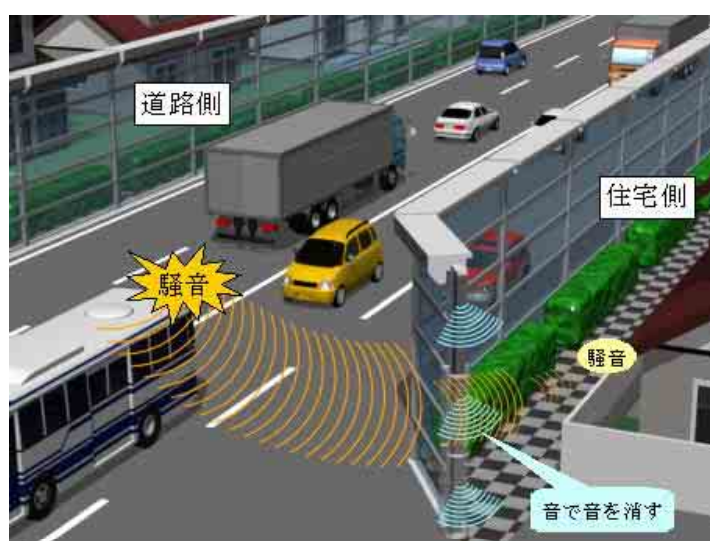
図7 縦型アクティブ遮音壁のメカニズム
