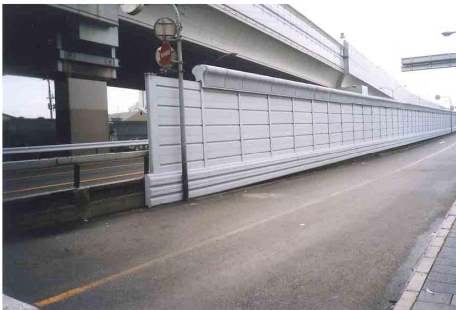
写真 19 光触媒によるフィールド実験（尼崎市域：H14年度施工）
