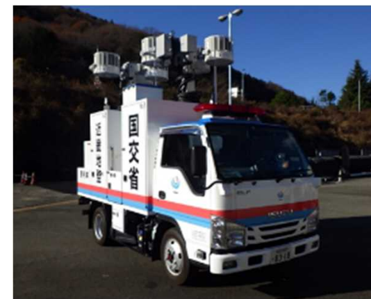
夜間の災害現場を照らす車
