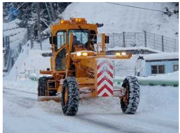
除雪グレーダーによる除雪(前から)
