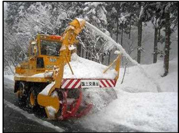
▲ロータリー除雪車による除雪
