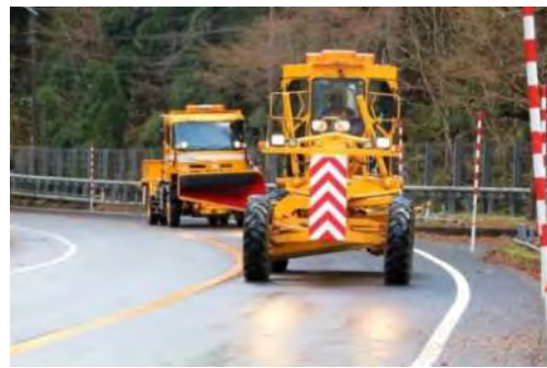
出動する除雪グレーダと除雪トラック
