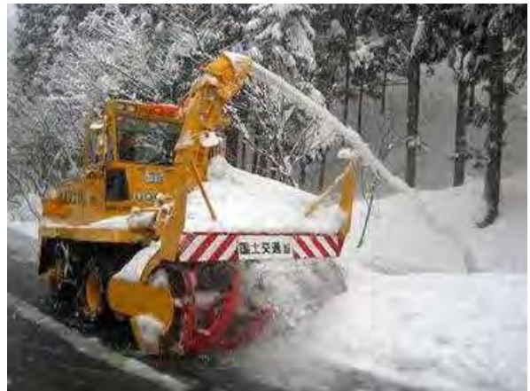
ロータリ除雪車による除雪(前から)
