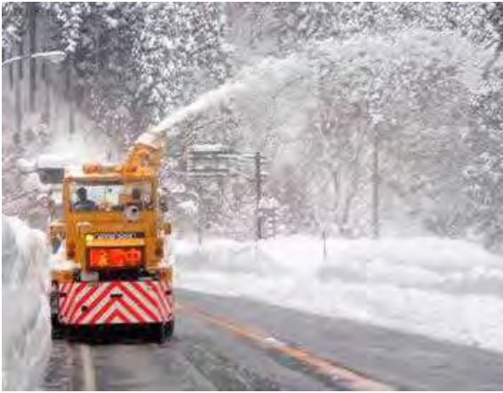
ロータリ除雪車による除雪(後ろから)
