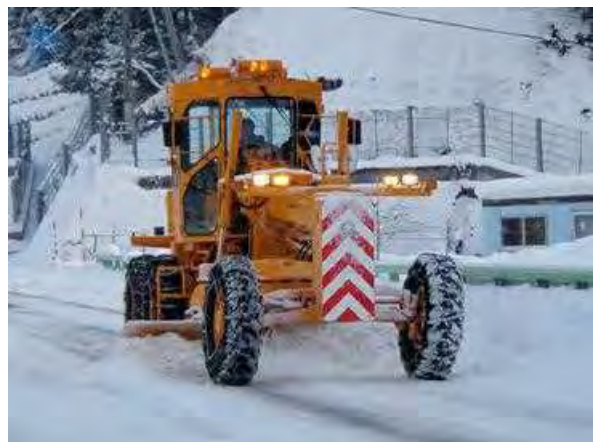
除雪グレーダによる除雪(前から)
