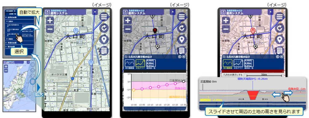
危機管理型水位計運用システム(川の水位情報)イメージ
