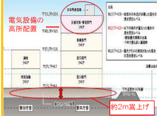
新庁舎建設に伴う敷地の嵩上げ、電気設備の高所配置等(高砂市)
