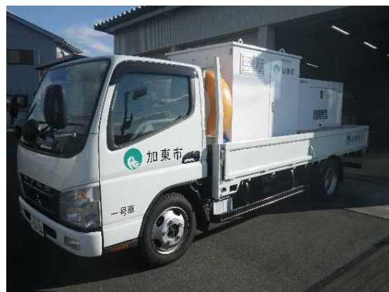
排水ポンプパッケージ車
